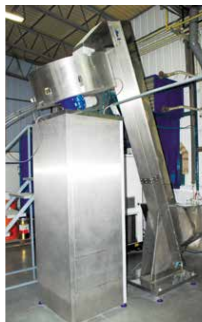
Proizvodnja dozatora sa elevatorom za "Stel cap" zatvarače
